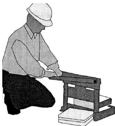
Рисунок 23 – Изготовление дополнительных элементов с помощью гильотины
